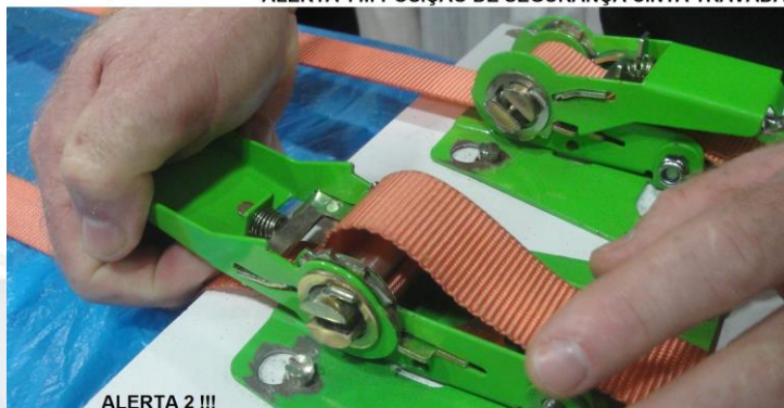
ALERTA 2 !!! POSIÇÃO ABERTA 180° APERTAR GATILHO PARA DESTRAVAR E SOLTAR A CINTA.
