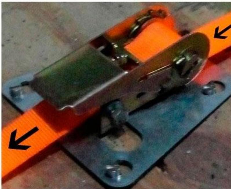
**Introduzir a cinta de poliéster no cilindro metálico da catraca. Passar toda a cinta, esticando para evitar sobras e iniciar o procedimento de movimento de aperto da cinta, não ultrapassando o limite de 6 movimentos de apertos.**
