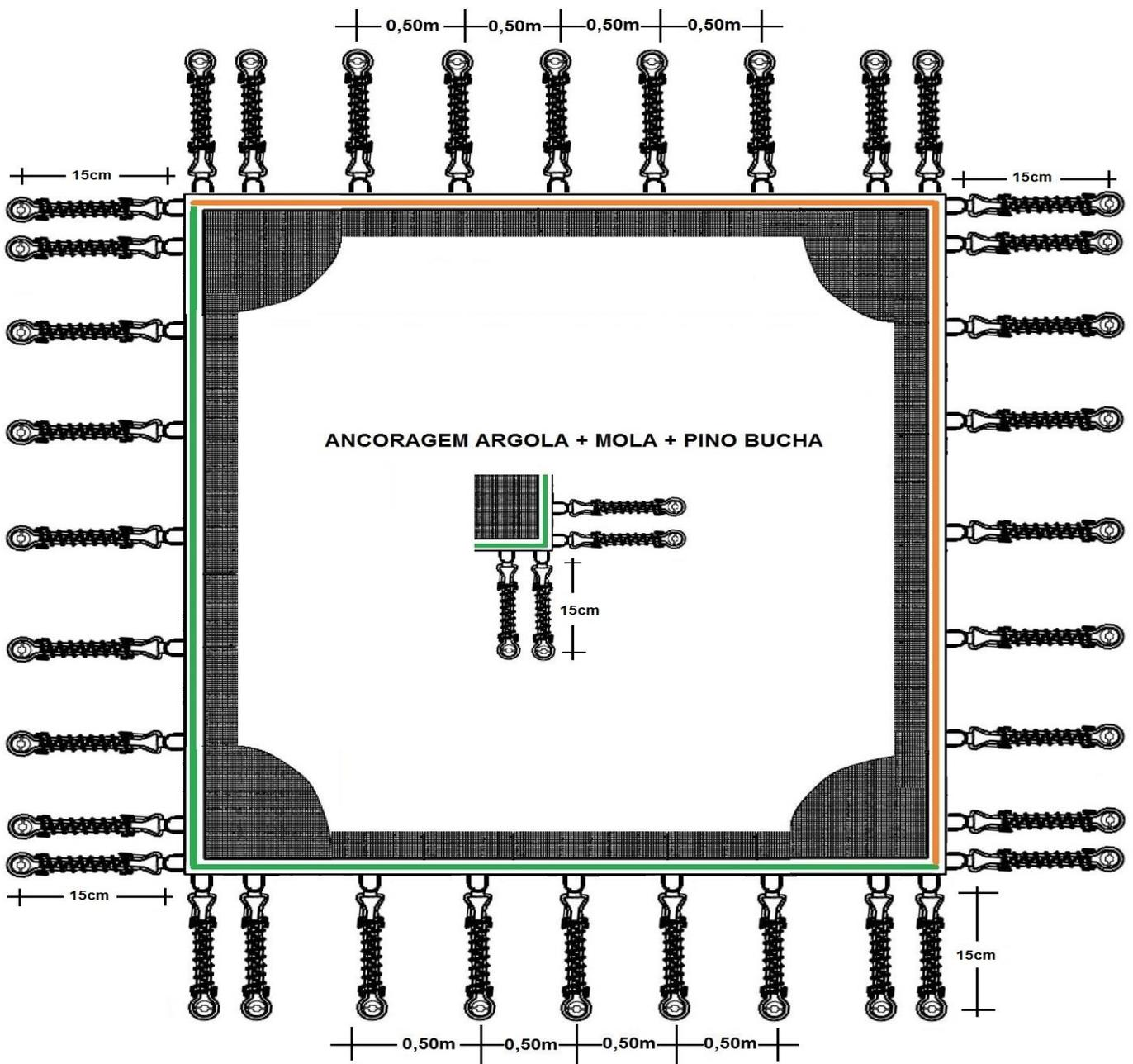
5- Iniciar sua instalação através dos 4 cantos da capa. Colocar os pinos oscilantes nas buchas, elevando-os 3 mm , colocar uma extremidade da mola na argola de aço e a outra na haste da CHAVE DE
