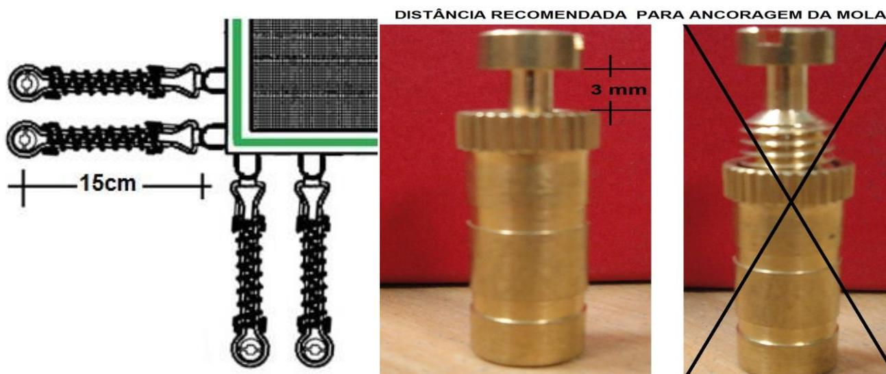
8- Retire o pino central roscado na bucha, e introduza o PINO BATEDOR NO ORIFÍCIO DA BUCHA para bater com o MARTELO, até que a bucha fique nivelada com o piso. Reponha o pino central deixando um afastamento de 3 mm para engatar a mola.
