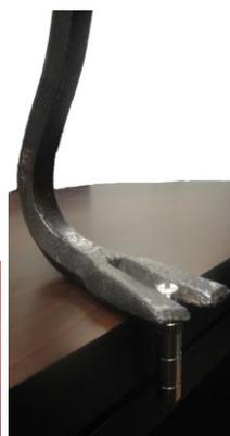
\*Recomendamos sempre posicionar a furação do piso centralizado de acordo com as argolas de ancoragem do pino-bucha, bem como fazer a furação sempre a 90° em relação as argolas de aço Inox da Capa Piscina. Ocorrendo erro de marcação dos pontos de fixação do pino bucha recomendamos utilizar a ferramenta pé-de-cabra com comprimento de 80cm de cabo para facilidade da extração do pino bucha ora embutido. Refazer a furação e reinstalar conforme orientação em nosso manual de instalação.
