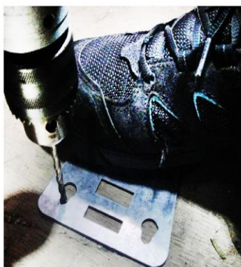
Furo inicial diâmetro 5mm e furo final diâmetro 10mm
