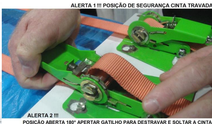
Fixar as bases metálicas utilizando 4 pinos-bucha conforme ilustração
